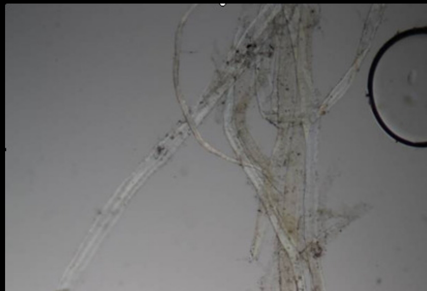
Microscopio: pasta de madera con algunas fibras de algodón (s. XIX)
