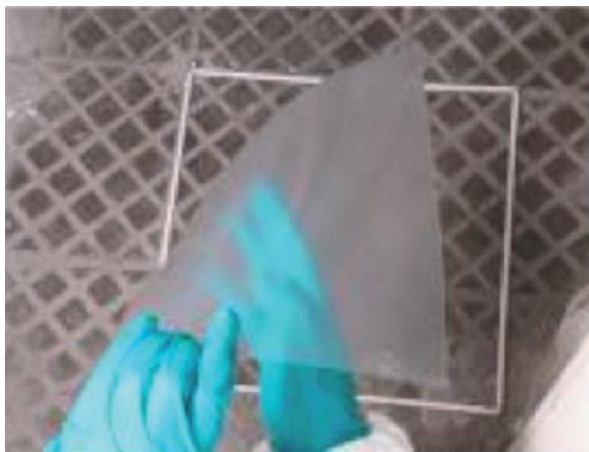
← Levantamiento de evidencia en el piso del baño, mediante lámina adhesiva de polivinilo. Fotografía: M. Roubillard, 2011. Archivo CNCR.
